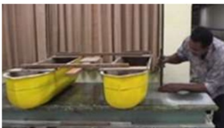
Gambar 12. Model Uji Tahanan Kapal
