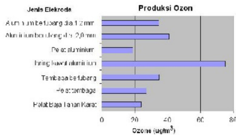
Gambar 7 Perbandingan produksi reaktor ozon dengan elektroda berbeda
