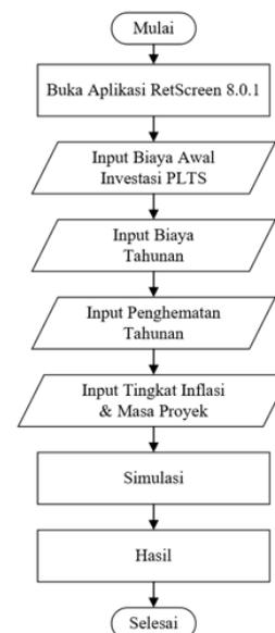
Gambar 5. Diagram Alir Pengoperasian Perangkat Lunak RetScreen 8.0.1
