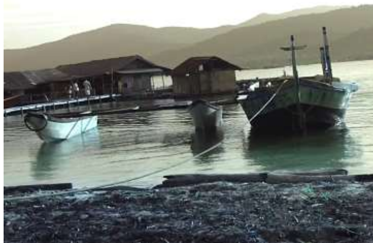
Gambar 2. Kapal ikan 10 GT sebagai main hull yang akan dimodifikasi dengan menambahkan sidehull yang akan membentuk kapal trimaran.
