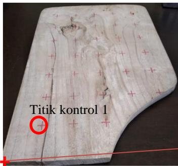
**Gambar 1.** Objek, pusat koordinat dan posisi titik kontrol pada objek papan kayu
