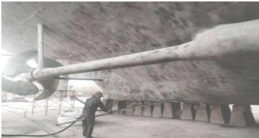
Gambar 3. Kegiatan Sandblasting process KMP. Doro Londa menggunakan alat pelindung diri Sesuai aturan K3L
