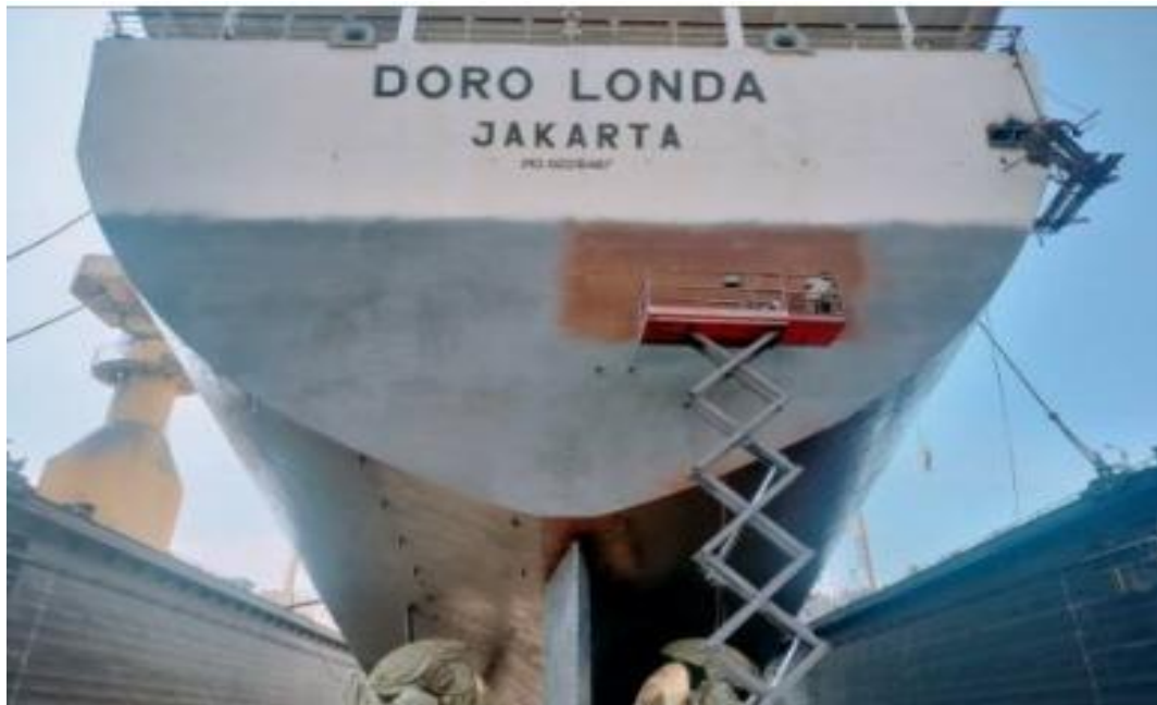
Gambar. 4 Kegiatan Coating process KMP. Doro Londa menggunakan alat ketinggian
