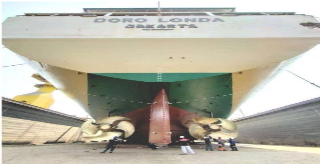
Gambar. 5 Kegiatan Final Coating Inspection KMP. Doro Londa menggunakan APD lengkap dan menerapkan standar K3L
