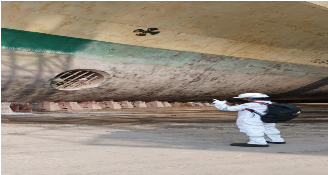
Gambar 2. Kegiatan General Inspection Coating oleh BKI Class menggunakan APD lengkap
